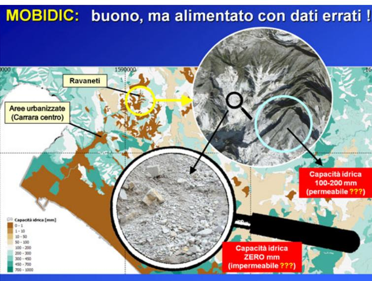
Per farla breve, abbiamo scoperto che il modello idraulico è stato alimentato con dati errati. In particolare, i ravaneti sono stati considerati impermeabili come le aree urbanizzate, mentre i nudi versanti rocciosi sarebbero permeabili: un assurdo logico!
